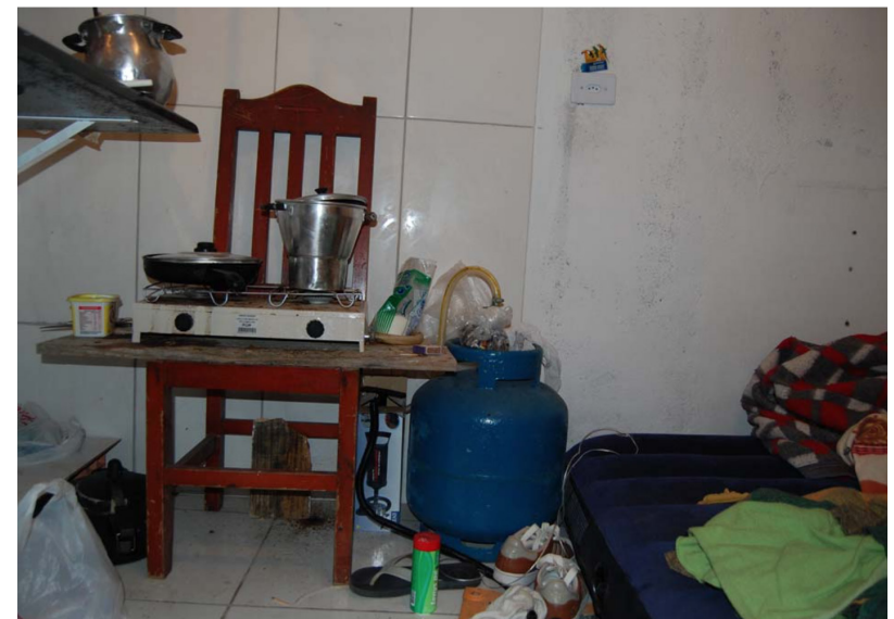
4. Alojamento: botijão de gás desprotegido e interno, risco de explosão
